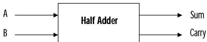
รูปที่ 6.5 โครงสร้างวงจรบวกแบบไม่คิดตัวทด
