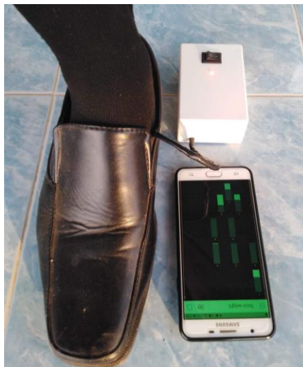
รูปที่ 5 การประกอบแผ่นวัดแรงกดที่เข้าร่วมกับการใช้งานจริง
