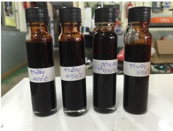
รูปที่ 8 ลักษณะของน้ำมันชีวภาพที่ได้จากไพโรไลซิสแบบเร็วของชานอ้อย จากหน่วยผลิตที่ใช้เครื่องปฏิกรณ์ทั้ง 4 อุณหภูมิตามเงื่อนไข
