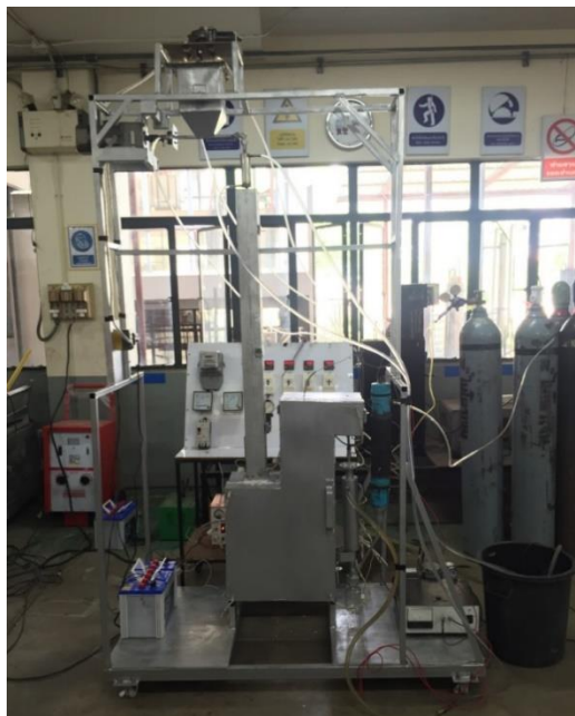
รูปที่ 4 หน่วยผลิตไพโรไลซิสแบบเร็วที่ใช้เครื่องปฏิกรณ์แบบตกอิสระสำหรับการใช้การศึกษา
