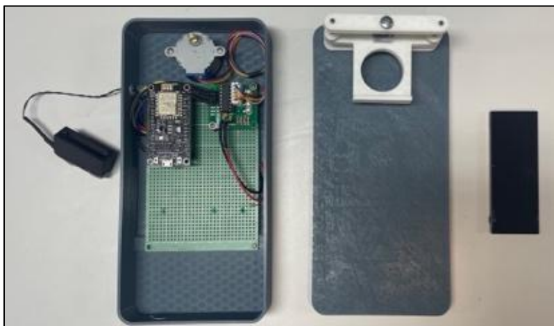
รูปที่ 5 ภายในโมเดลกล่องจุลทรรศน์ชนิดดาร์กฟิลด์ขนาดพกพา
