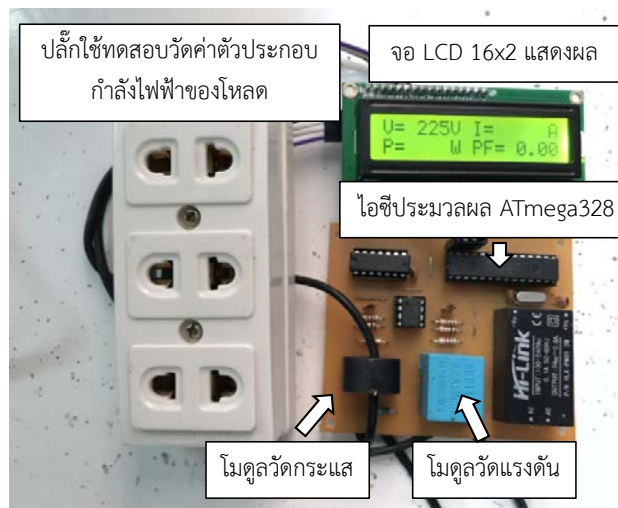
รูปที่ 4 ลักษณะโครงสร้างอุปกรณ์จริงของวงจรวัดค่าตัวประกอบกำลังไฟฟ้า
