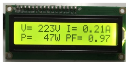
รูปที่ 10 หน้าจอแอลซีดี 16x2 แสดงค่าแรงดันไฟฟ้า กระแสไฟฟ้าและค่าตัวประกอบกำลังไฟฟ้า
