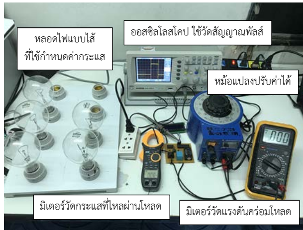
รูปที่ 5 การติดตั้งอุปกรณ์ทดลองวัดความถูกต้องของแรงดันและกระแสไฟฟ้า
