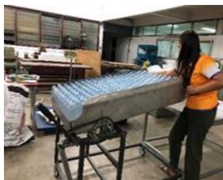
รูปที่ 6 ตัวอย่างวิธีการใช้บล็อกบรรจุห่อ
