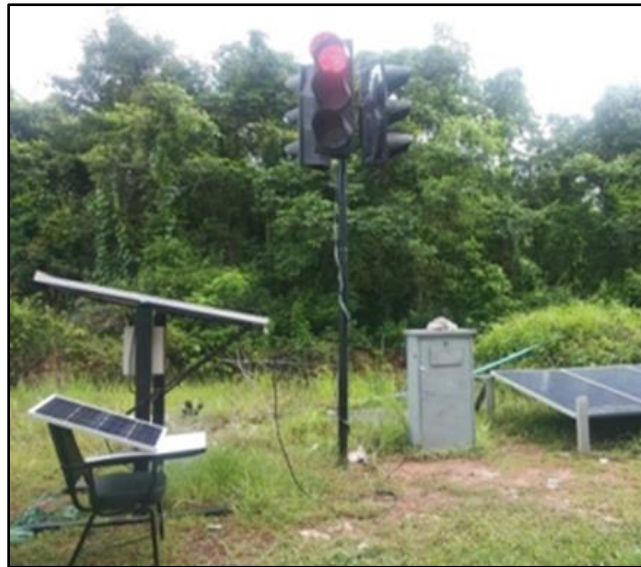
รูปที่ 4 ชุดสัญญาณไฟจราจรพลังงานไฮบริดที่สมบูรณ์
