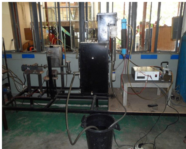
รูปที่ 1 ไดอะแกรมหน่วยผลิตไพโรไลซิสแบบเร็วของชีวมวลที่เครื่องปฏิกรณ์ฟลูอิดไคเซเบต
