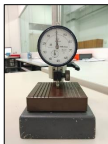
B) ภาพการติดตั้งไดอัลเกจ เข้ากับตัวฐานจับ
