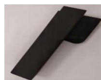
รูปที่ 4 อุปกรณ์จับยึดมีดกลึงที่พิมพ์ด้วยเครื่องพิมพ์แบบ 3 มิติ
