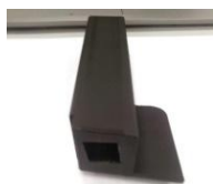
รูปที่ 4 อุปกรณ์จับยึดมีดกลึงที่พิมพ์ด้วยเครื่องพิมพ์แบบ 3 มิติ
