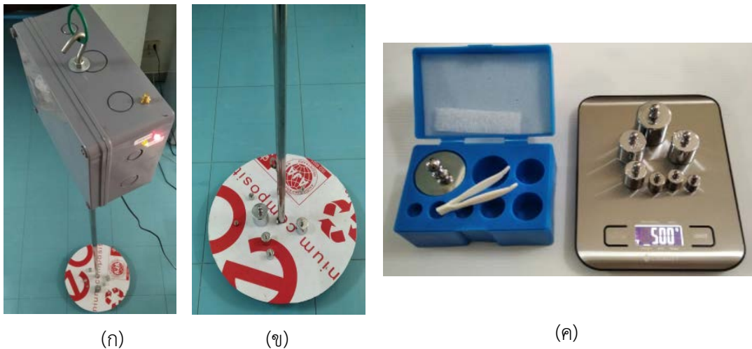
รูปที่ 6 การทดสอบเครื่องซ่งกับลูกตุ้มน้ำหนักมาตรฐาน
