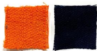
รูปที่ 9 ตัวอย่างผ้าที่จะบรรจุเข้าเครื่องอัดฯ ขนาด 30 x 30 มิลลิเมตร
