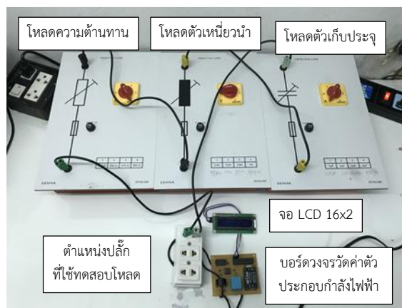
รูปที่ 8 การติดตั้งโหนดเพื่อกำหนดค่าตัวประกอบกำลังไฟฟ้า
