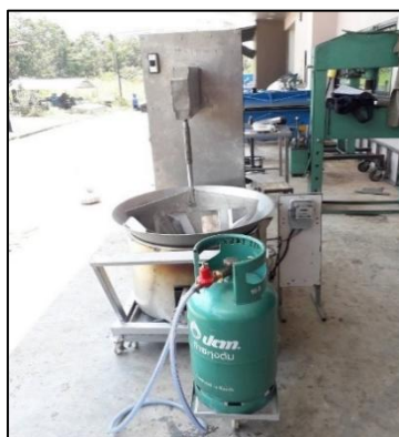
รูปที่ 2 เครื่องกวนผลิตกัณฑ์อ้อยผงชนิดให้ความร้อนด้วยแก๊สปิโตรเลียมเหลว
