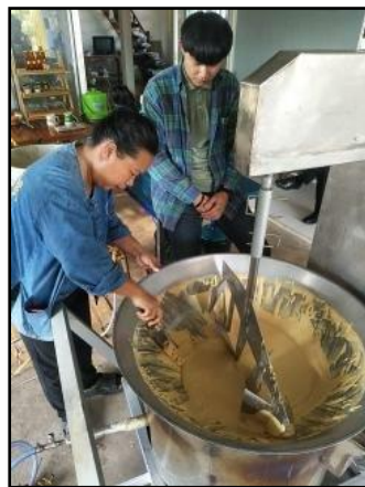
รูปที่ 3 กระบวนการผลิตอ้อยผงชนิดให้ความร้อนโดยแก๊สปิโตรเลียมเหลว
